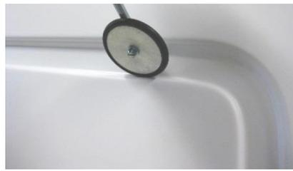
Die 3M Roller S und L ermöglichen eine ermüdungsfreie, zügige und sichere Applikation der Folien in Vertiefungen und stellen eine gleichmäßige, kontinuierliche Andruckkraft in den Kanten der Vertiefungen sicher.
