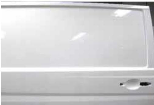
Die Folie auf die zu beklebende Fläche legen und mit Application Tape erst an beiden Seiten und dann oben fixieren.
