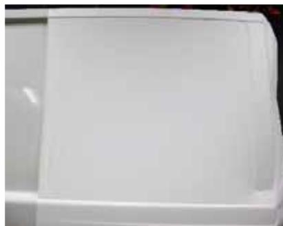
Bei Verklebung einer Grafik innerhalb der einfachen Vertiefung darf die Folie nicht näher als 20 cm an die Sicke verklebt werden. Es muss genügend Folienmaterial freischwebend vorhanden sein, um ein eventuelles Ablösen der Folie in der Sicke zu verhindern.
